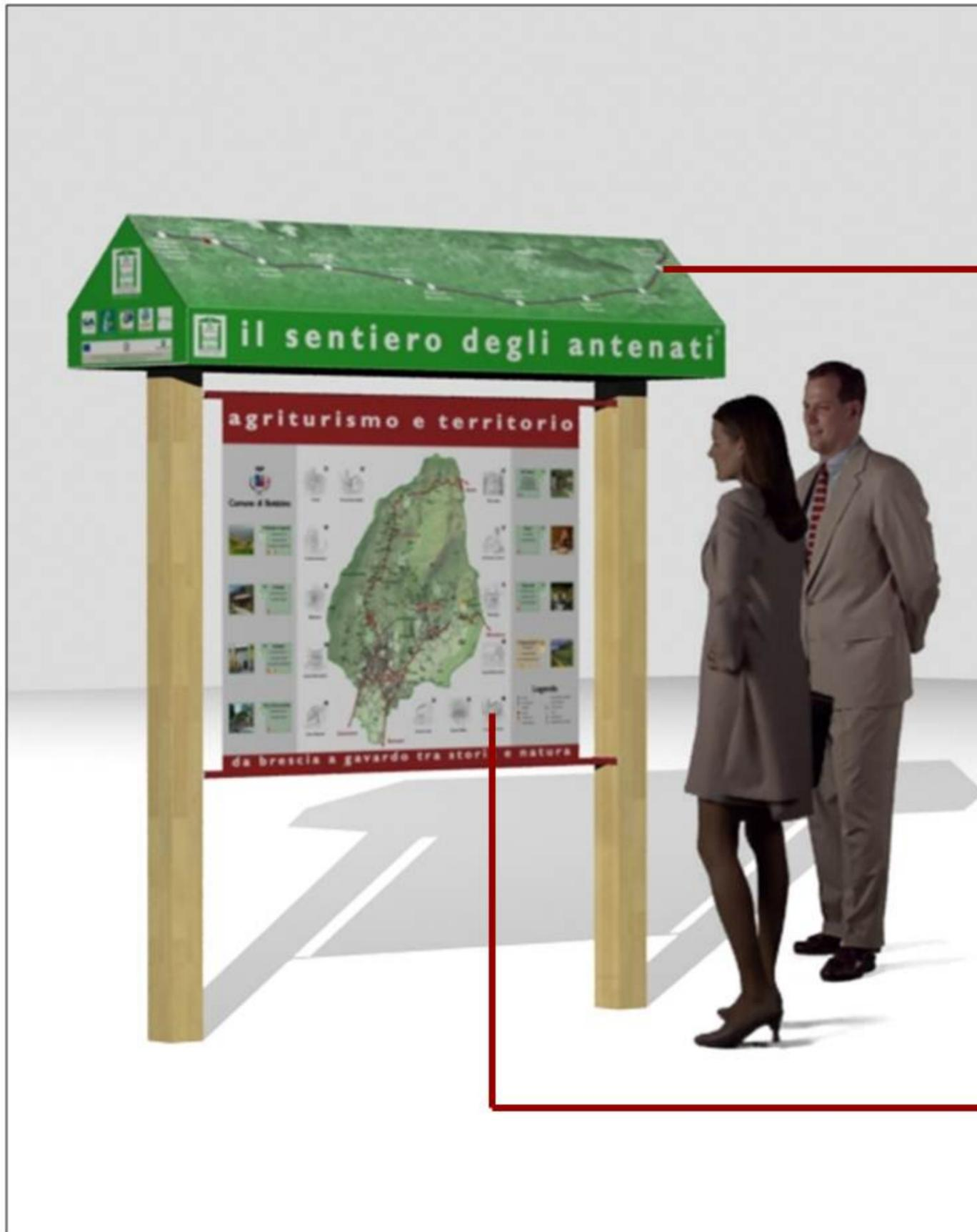
La *bacheca* è caratterizzata da due elementi principali: il *tettuccio* e la mappa. Essi sono sorretti da due semplici pali in legno infissi nel terreno tramite appositi puntali metallici ed il montaggio dell'intera struttura avviene tramite assemblaggio a secco dei singoli elementi.
